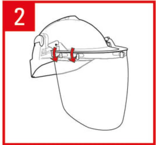
1. Posicionar el visor sobre la traba central del adaptador para casco y rotarla 90°.
